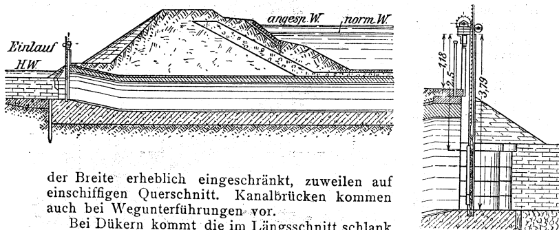
Gemauerter Düker des Dortmund - Ems-Kanals.
