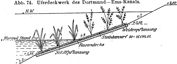
Abb. 74. Uferdeckwerk des Dortmund-Ems-Kanals.
